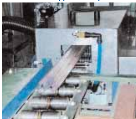
2 Nanošenje učvršćivača za drvo na pjevnim dijelovima
